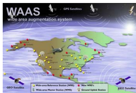
Фиг.2 Архитектура на континентална допълваща система – WAAS, USA
