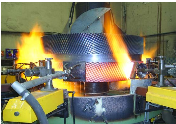
Фиг.3 Газо-пламъчно нагряване на полоса долна на зъбния венец.
