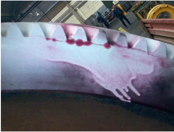
Фиг.8 Пукнатини в зъбите на полоса „долна“.
