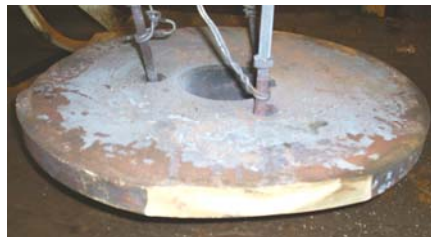
Фиг. 6 Разрушен борд от валцов диск по време на охлаждането.
