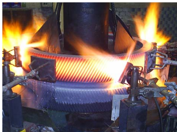
Фиг.7 Газо-пламъчно нагряване на полоса „горна“ на зъбния венец.
