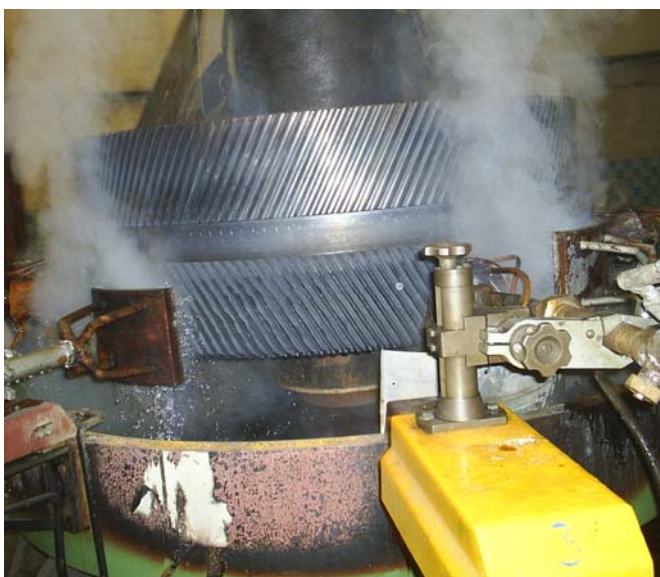
Фиг.5 Охлаждане на полоса долна на зъбния венец.
