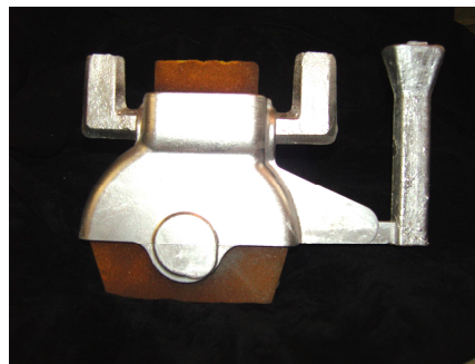
Фиг. 9 Отливка с пясъчно сърце
